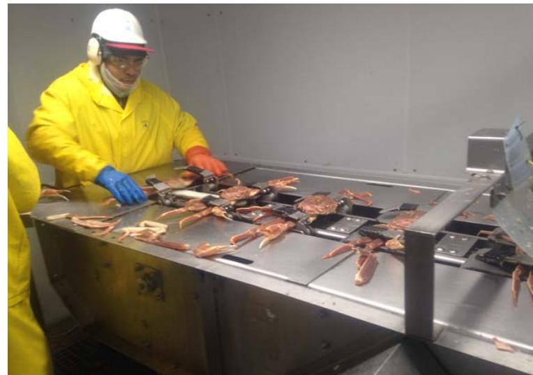
Производительность автоматической машины 30-40 крабов в минуту позволит одной машине с двумя операторами заменить 4 рабочих занимающимся ручной разделкой краба.
